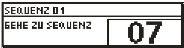
Durch drücken und halten von  $\triangle$  und  $\nabla$  kann eine neue Sequenz eingestellt werden (1 – 32). Mit  wird der neue Wert gespeichert, mit  der alte Wert beibehalten.
