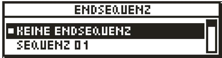
Durch drücken und halten von  $\triangle$  und  $\nabla$  kann eine neue Sequenz als Endsequenz definiert werden. Mit  $\checkmark$  wird die neue Sequenz gespeichert, mit  $\times$  die alte Sequenz beibehalten. Im Autostart Modus spielt der XRC-150 immer die Endsequenz beim drücken von  $\blacksquare$  ab.
