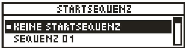
Durch drücken und halten von  $\triangle$  und  $\nabla$  kann eine neue Sequenz als Startsequenz definiert werden. Mit  wird die neue Sequenz gespeichert, mit  die alte Sequenz beibehalten.
