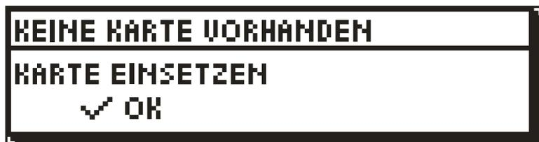
Die Karte muss eingesetzt und  gedrückt werden. Der XRC-150 funktioniert nur wenn eine Karte eingesetzt ist
