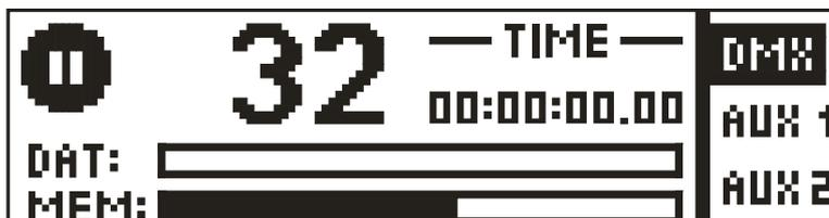
Der DMX Eingang wird nun direkt an den Ausgang weitergeschaltet, so dass man immer direkt sehen kann was aufgenommen wird.
