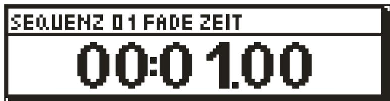
Durch drücken und halten von  $\triangle$  und  $\nabla$  kann die Fade Zeit geändert werden (00:00.00 – 54:36.75). Das Zeitformat ist: Minuten: Sekunden. Hundertstelsekunden. Mit  $\checkmark$  wird der neu eingestellte Wert übernommen, mit  $\times$  der alte Wert beibehalten. Wählt man „alle Sequenzen“ kann die Fade Zeit für alle Sequenzen auf den gleichen Wert eingestellt werden.
