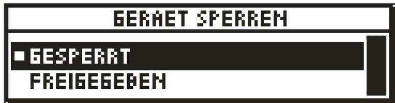
Mit  $\triangle$  und  $\nabla$  erfolgt die Auswahl ob der XRC-150 gesperrt oder freigegeben werden soll. Die Auswahl muss mit  bestätigt werden. Die Markierung ■ zeigt den aktuellen Zustand an.
