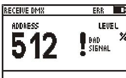
Kann das empfangene Signal vom XMT nicht decodiert werden, wird BAD SIGNAL anstelle des DMX Kanalwertes angezeigt.
