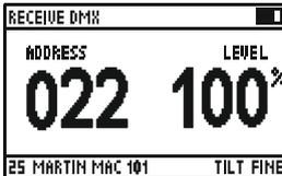
Ist ein gerät adressiert, wird im RECEIVE DMX und im SEND DMX Modus die Informationen über Gerät und Kanalbeschreibung am unteren Rand des Displays angezeigt.
