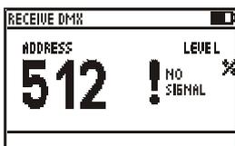
Wird kein Signal empfangen wird NO SIGNAL anstelle des DMX Kanalwertes angezeigt.
